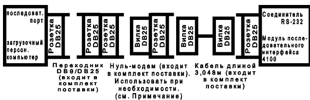
Рисунок 3 – Модуль с персональным компьютером, имеющим соединитель в виде вилки DB25
