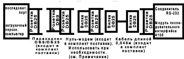
Рисунок 4 – Модуль с персональным компьютером, имеющим соединитель в виде вилки DB25
